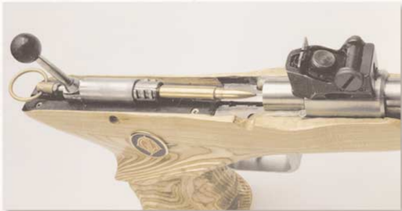
Ein kurzer Geschützverschluss mit Patronenhalter. Man beachte die hohe Position des Visieres.
